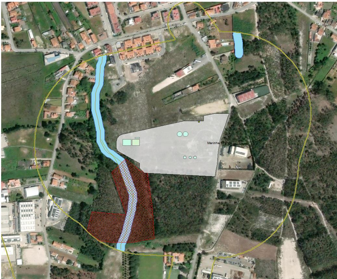
Figura 8 - Interferência do estaleiro com o domínio hídrico
